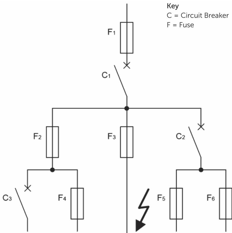
FIG. 5: SELECTIVITY BETWEEN FUSE-LINKS IN A TYPICAL THREE-PHASE DISTRIBUTION SYSTEM (ONLY ONE PHASE SHOWN)
